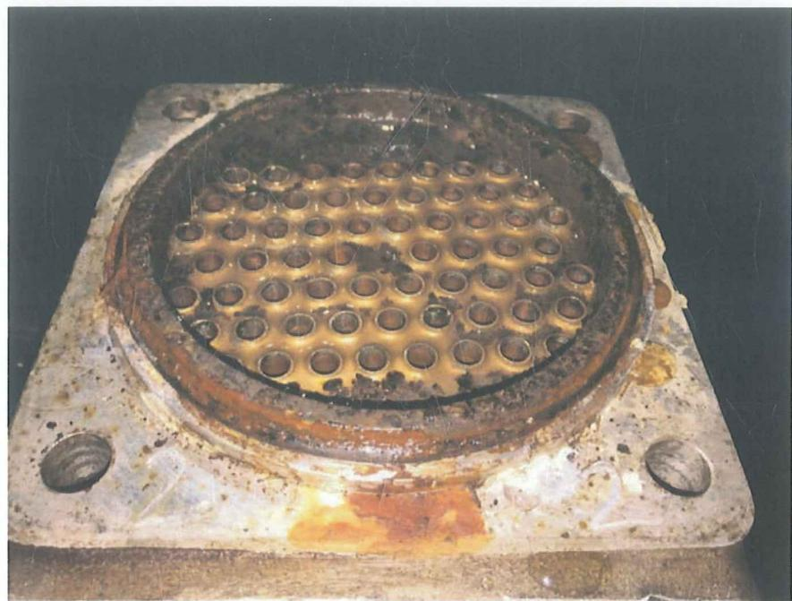
图 18: 3号机 2号冷却器管道完全无污垢, 且大面积漏出了金属色, 原有腐蚀情况得到改善
