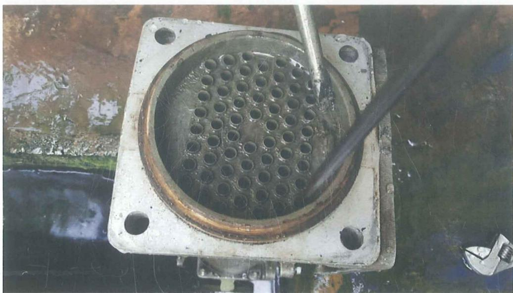
图 15：9月13日5号空压机油冷器拆检图片
